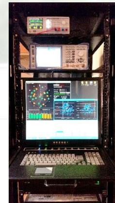
Лабораторный стенд по спутниковой навигации
